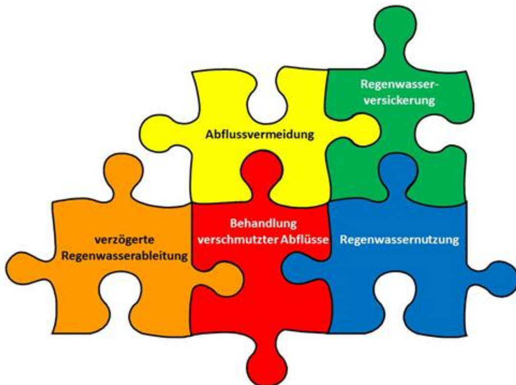
Abbildung 19: Elemente des Integralen Regenwassermanagements (aus DWA 2020)
