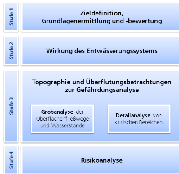
ABBILDUNG 31 STUFENKONZEPT ZUR ERSTELLUNG EINER URBANEN GEFAHRENKARTE (DR. PECHER AG 2014)
